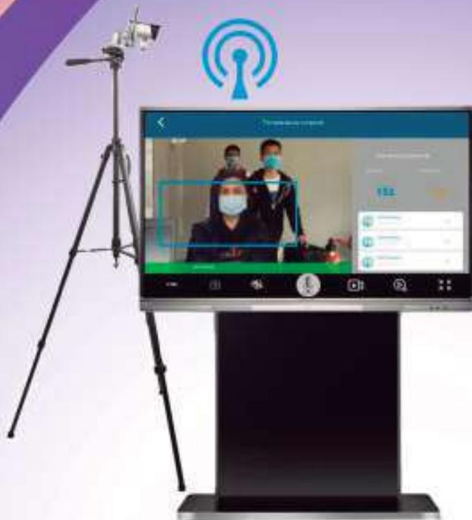
A tela digital pode ser instalada com o software de TV, conectar a câmera via Wi-Fi, ou ainda via cabo com de rede local (LAN). A câmera também pode ser conecta por via remota, garantindo o recebimento do vídeo ao vivo além da medição da temperatura. Os dados estatísticos serão exibidos em tempo real na tela digital e ao mesmo tempo, é possível verificar o registro histórico de medição da temperatura, gravação de imagem e executar a reprodução de vídeo.
